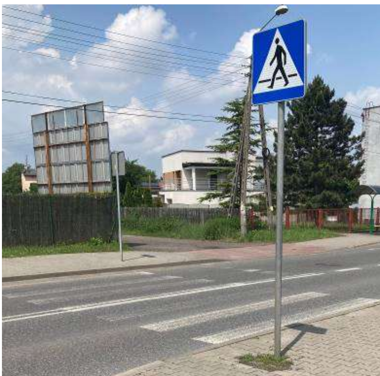
Rysunek 59. Brak obniżonego krawężnika i prawie niewidoczne przejście dla pieszych przy przystanku Kochłowice Krzyż
