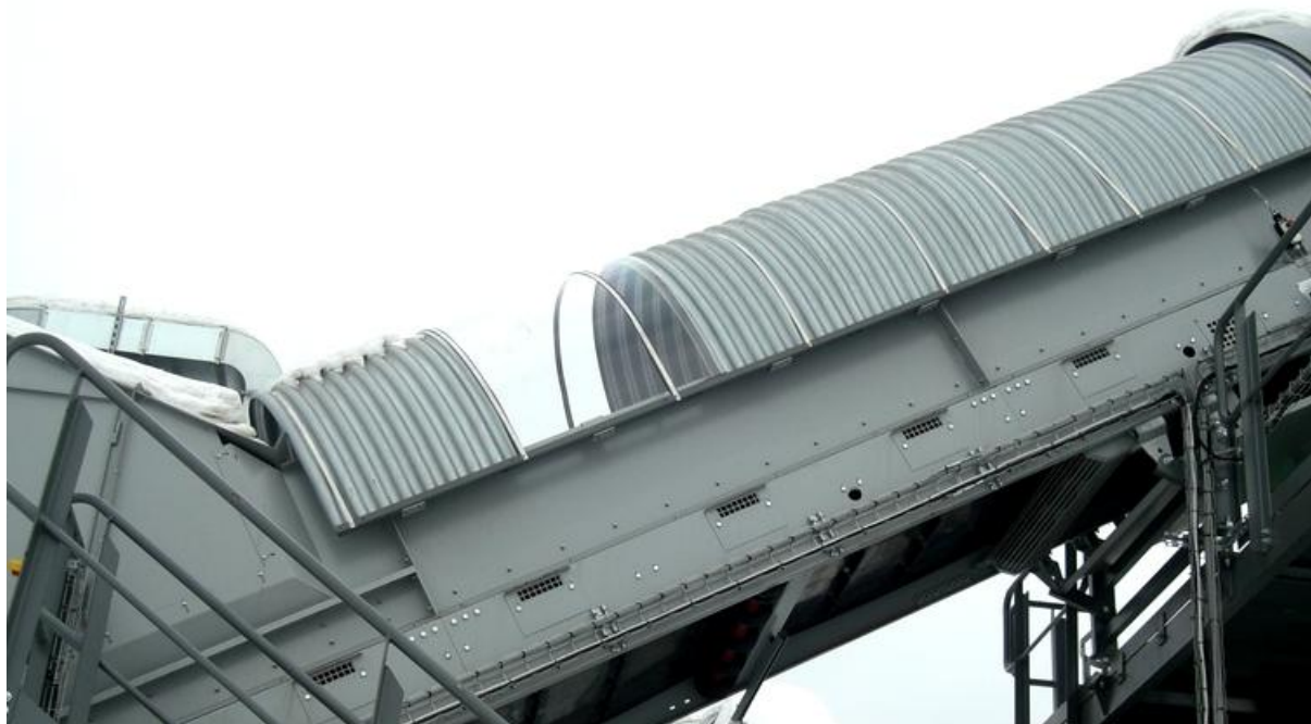
Rysunek 10: Przykładowy taśmociąg osadu wysuszonego.
