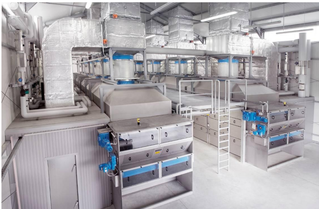
Rysunek 9: Przykładowe rozwiązanie taśmowej suszarni osadu.
