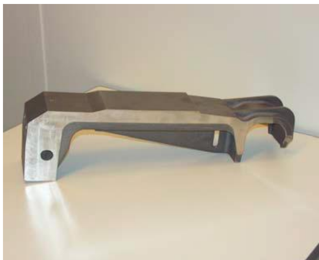
Rysunek 16: Pojedyncza rusztowina - ruszt chłodzony powietrzem.
