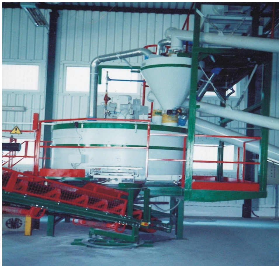
Rysunek 34: Przykład mieszalnika stożkowego stosowanego w procesie stabilizacji i zestalania.
