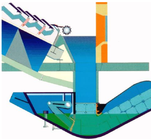
Rysunek 20: Przykładowa konstrukcja układu odżużlania.
