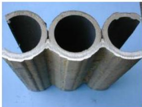
Rysunek 23: Przekrój ścian membranowych poddanych napawaniu.
